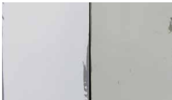
Usporedba akrilnog premaza Jubin Decor (lijevo) s konvencionalnim konkurentskim alkidnim premazom na osnovi otapala (desno).
